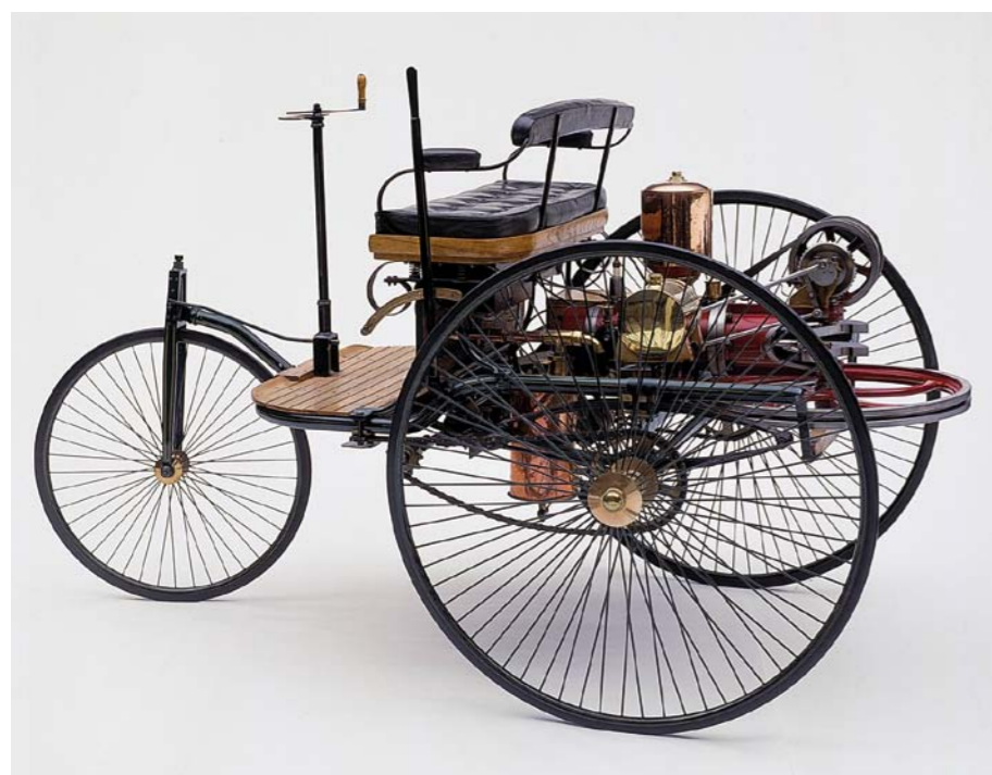
TRÓJKOŁOWIEC KARLA BENZA I JEGO LEKKI SILNIK CZTEROSUWOWY ZAINAUGUROWAŁY EPOKĘ MOTORYZACJI SPALINOWEJ
