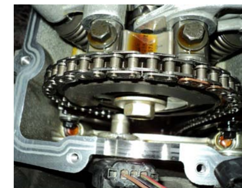
TRWAŁOŚĆ ŁAŃCUCHOWEGO NAPĘDU ROZRZĄDU ZALEŻY BEZPOŚREDNIO OD JAKOŚCI OLEJU SMARUJĄCEGO SILNIK
