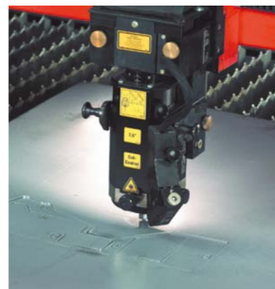
OD LEWEJ: CIĘCIE LASEROWE BLACH O GRUBOŚCI 5 MM, CIĘCIE LASEROWE BLACH CIENKICH, GŁOWICA LASEROWA PODCZAS CIĘCIA STALI WYSOKOSTOPEWYJ – WIĄZKA JEST NIEMAL NIEMAL NIEWIDOCZNA
