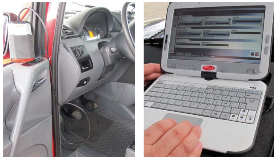
TESTER DELPHI DS150E SKŁADA SIĘ Z CZĘŚCI PODŁĄCZANEJ DO GNIAZDA DIAGNOSTYCZNEGO POJAZDU I SKOMUNIKOWANEGO Z NIĄ BEZPRZEWODOWO STANDARDOWEGO KOMPUTERA
