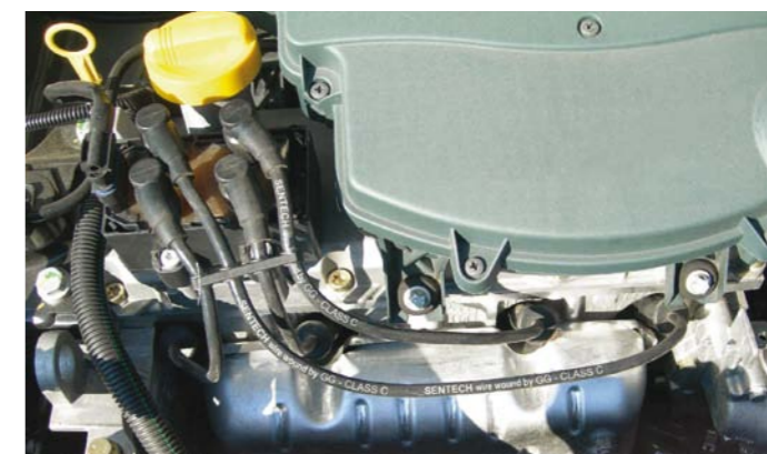
WIĄZKA PRZEWODÓW ZAPŁONOWYCH ZAMONTOWANA W SILNIKU PRZY UŻYCIU ELEMENTÓW SPINAJĄCYCH, MOCUJĄCYCH, PROWADZĄCYCH I OSŁONOWYCH
