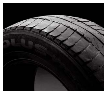
CHARAKTERYSTYCZNE ZUŻYCIE BIEŻNIKA OPONY POWODOWANE PRZEZ NIESPRAWNY AMORTYZATOR
