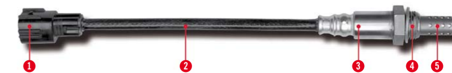
CZĘŚCI SKŁADOWE SONDY: 1. WTYCZKA, 2. PRZEWÓD, 3. KORPUS, 4. GWINT KORPUSU, 5. RURKA OCHRONNA SONDY
