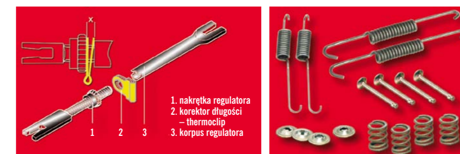
TYCH CZĘŚCI PRZEWAŻNIE NIE WYMIENIA SIĘ PODCZAS TRADYCYJNEJ NAPRAWY HAMULCA. CHOĆ ONE RÓWNIEŻ ULEGAJĄ KOROZYJNEMU I CIERNEMU ZUŻYCIU
