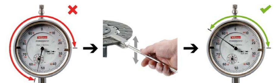
BICIE BOCZNE \geq 0,5 MM. PROSTOWANIE TARCZY SPRZĘGŁA. BICIE BOCZNE \leq 0,5 MM
