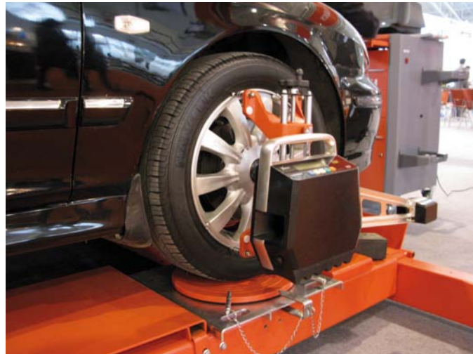
GŁOWICA AKTYWNA Z KAMERAMI CCD URZĄDZENIA LAUNCH X-631 GŁOWICA PASYWNA URZĄDZENIA LAUNCH X-712 3D
