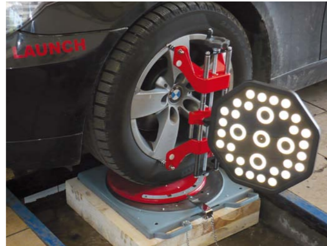
GŁOWICA AKTYWNA Z KAMERAMI CCD URZĄDZENIA LAUNCH X-631 GŁOWICA PASYWNA URZĄDZENIA LAUNCH X-712 3D
