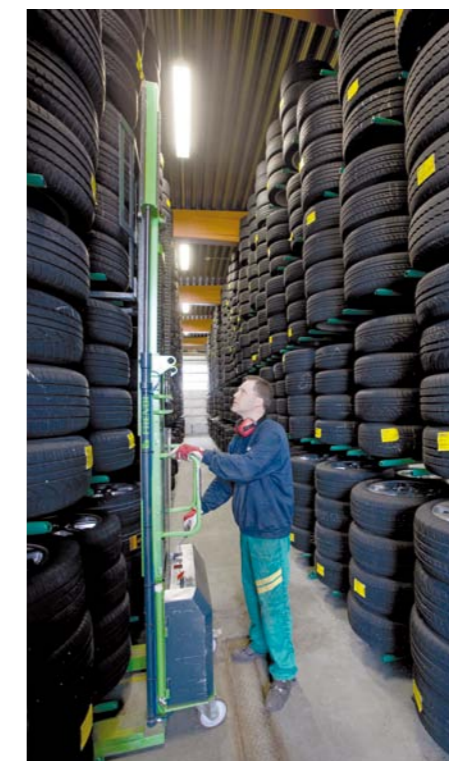
MECHANICZNY TRANSPORTER KÓŁ UMOŻLIWIA SPRAWNĄ I BEZPIECZNĄ PRACĘ MAGAZYNIERA ORAZ ZACHOWANIE MINIMALNYCH SZEROKOŚCI PRZEJŚĆ MIĘDZY REGAŁAMI
