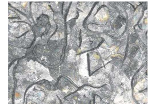
Z LEWEJ: MIKROSTRUKTURA ŻELIWA SZAREGO, NIESPEŁNIAJĄCA WYMAGAŃ JAKOŚCIOWYCH (OGNISKA KOROZJI PRZY PŁYTKACH GRAFITU). Z PRAWYJ: HOMOGENICZNA MIKROSTRUKTURA ŻELIWA W TARCZACH ORYGINALNYCH I PRODUKOWANYCH PRZEZ FIRMĘ ZIMMERMANN
