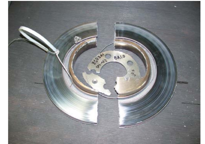
TARCZA HAMULCOWA NO NAME PO 81 PRÓBACH PRZECIĄŻENIOWYCH
