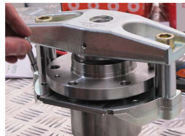
PODCZAS WPRASOWYWANIA KOMPLETNEGO MODUŁU DO GNIAZDA DWUCZĘŚCIOWE JARZMO OPOROWE PRZENOSI NACISK SIŁOWNIKA NA ZEWNĘTRZNY PIERŚCIEŃ ŁOŻYSKA
