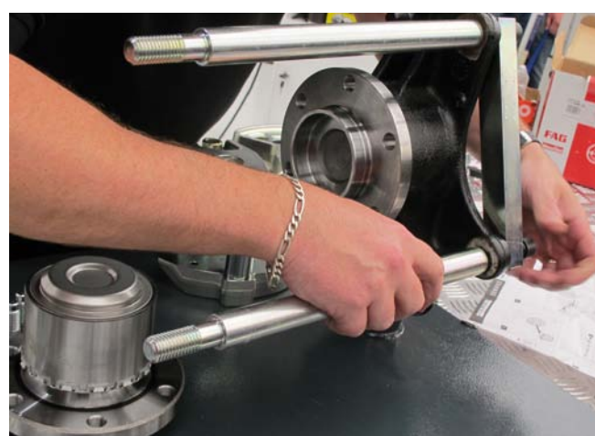
MOCOWANIE NARZĘDZIA MONTAŻOWEGO DO ZWROTNICZY (POZOSTAJĄCEJ W ZAWIESZENIU POJAZDU) PRZED DEMONTAŻEM ZUŻYTEGO ŁOŻYSKA WRAZ Z PIASTĄ KOŁA
