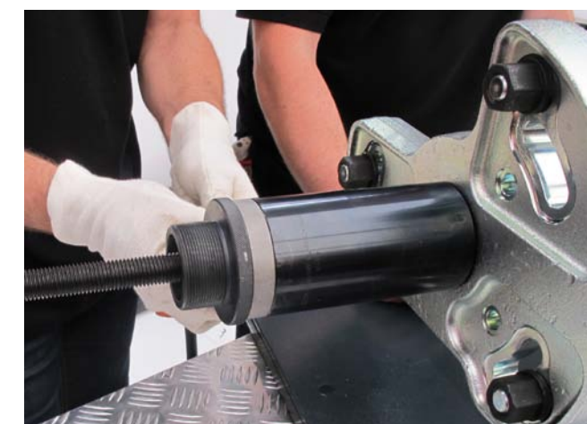
PRZY WCISKANIU NOWEGO ŁOŻYSKA SIŁOWNIK ŚCIĄGACZA PRACUJE JAKO PRASA
