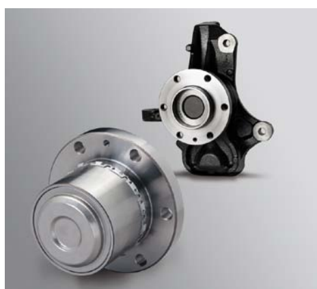
MODUŁ ŁOŻYSKA FAG. NA ŁOŻYSKU WIDĄC PIERŚCIEŃ OSADCZY ZE SPRĘŻYSTYMI ZACZEPAMI BLOKUJĄCYMI SIĘ W OBWODOWYM RÓWKU GNIAZDA ZWROTNICZY
