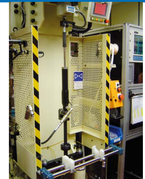
FABRYCZNE STANOWISKO DO BADANIA CHARAKTERYSTYK SIŁ AMORTYZATORÓW
