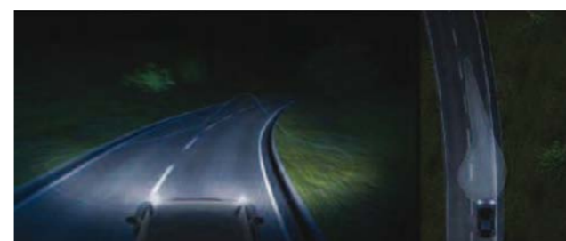
DOŚWIETLANIE ŁUKÓW DROGI; U GÓRY: LEWEGO, U DOŁU: PRAWEGO
