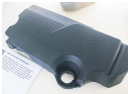
ABSORBUJĄCA HAŁAS POLIAMIDOWA OSŁONA SILNIKA
