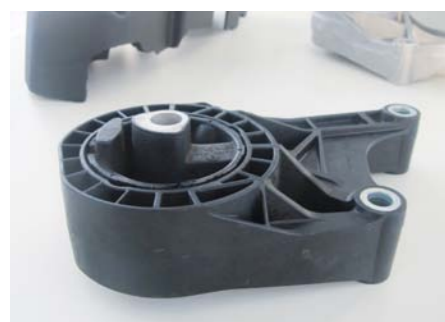
PLASTIKOWE ŁOŻYSKOWANIE DRAŻKA STABILIZATORA OPRACOWANE PRZEZ BASF WSPÓLNIE Z CONTITECH VIBRATION CONTROL
