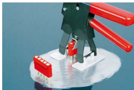
WSPÓŁPRACA SIŁOWNIKA DŹWIGNIOWEGO Z ZACZEPAMI ZGRZEWANYMI (ELEKTRODAMI)
