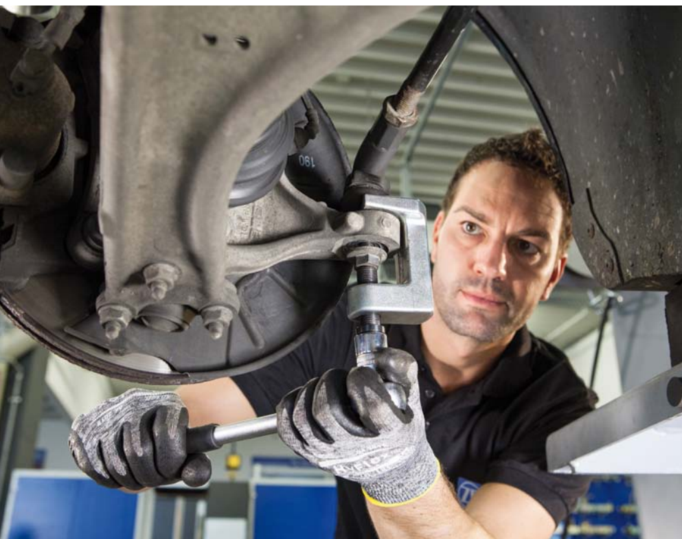
WYMIANA ZUŻYTEGO PRZEGUBU KULISTEGO JEST STOSUNKOWO PROSTA I TANIA, A ZAPEWNI RADYKALNĄ POPRAWĘ BEZPIECZEŃSTWA JAZDY
