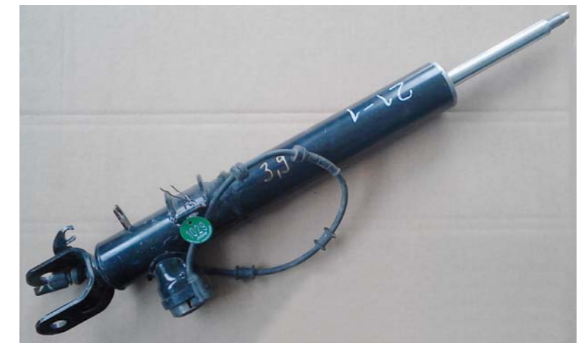
RYS. 5. AMORTYZATOR SYSTEMU ECDC PRODUKOWANY PRZEZ FIRME ZF
