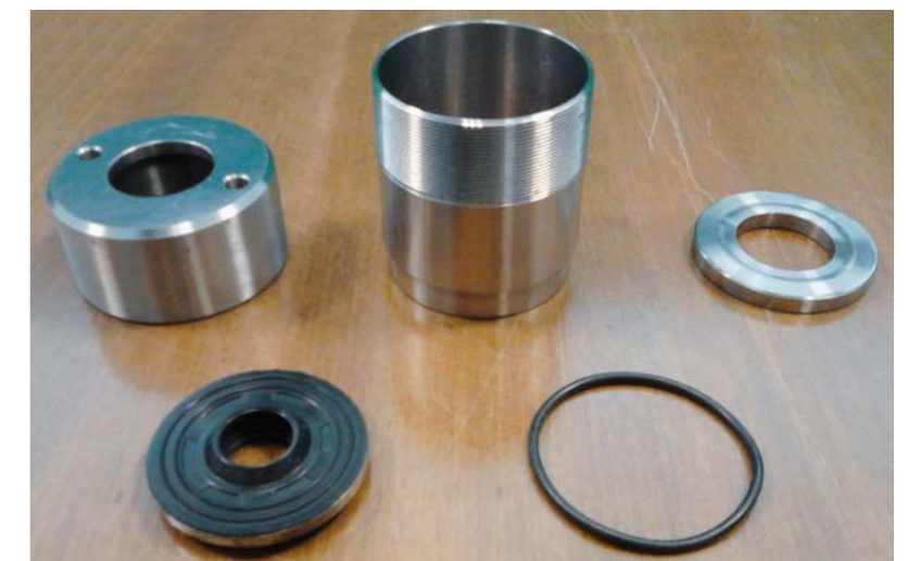
RYS. 7. ELEMENTY NAPRAWCZE AMORTYZATORA ECDC W OFERCIE FIRMY EMMETEC
