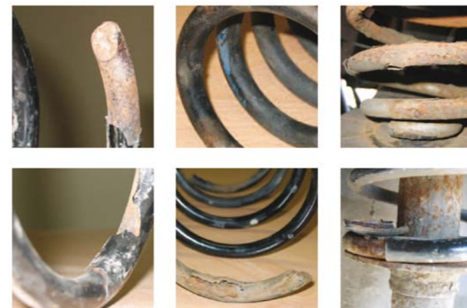
TYPOWE USZKODZENIA (OD GÓRY I OD LEWEJ): ZŁAMANY KONIEC, UBYTKI POWŁOKI, KOROZJA OGÓLNA, WŻERY KOROZYJNE, SKORODOWANY DOLNY ZWÓJ, ZŁAMANY DOLNY ZWÓJ
