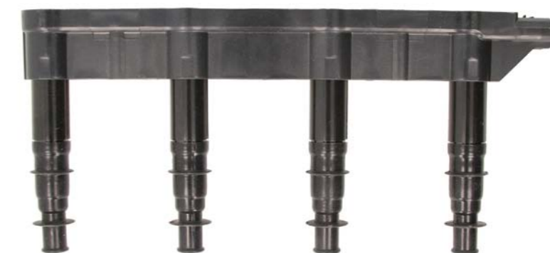
Z LEWEJ: INDYWIDUALNA CEWKA „OŁÓWKOWA” ZINTEGROWANA Z FAJKĄ ŚWIECY; Z PRAWIEJ: ZESPÓŁ CEWKI „OŁÓWKOWYCH” SILNIKA CZTEROCYLINDROWEGO UMIESZCZONYCH WE WSPÓLNEJ LISTWIE MONTAŻOWEJ
