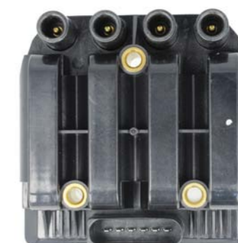
NOWOCZESNA CEWKA WSPÓŁPRACUJĄCA Z NISKONAPIĘCIOWYM (ELEKTRONICZNYM) ROZDZIELACZEM ZAPŁONU I CZTEREMA TRADYCYJNYMI KABLAMI ZAPŁONOWYMI
