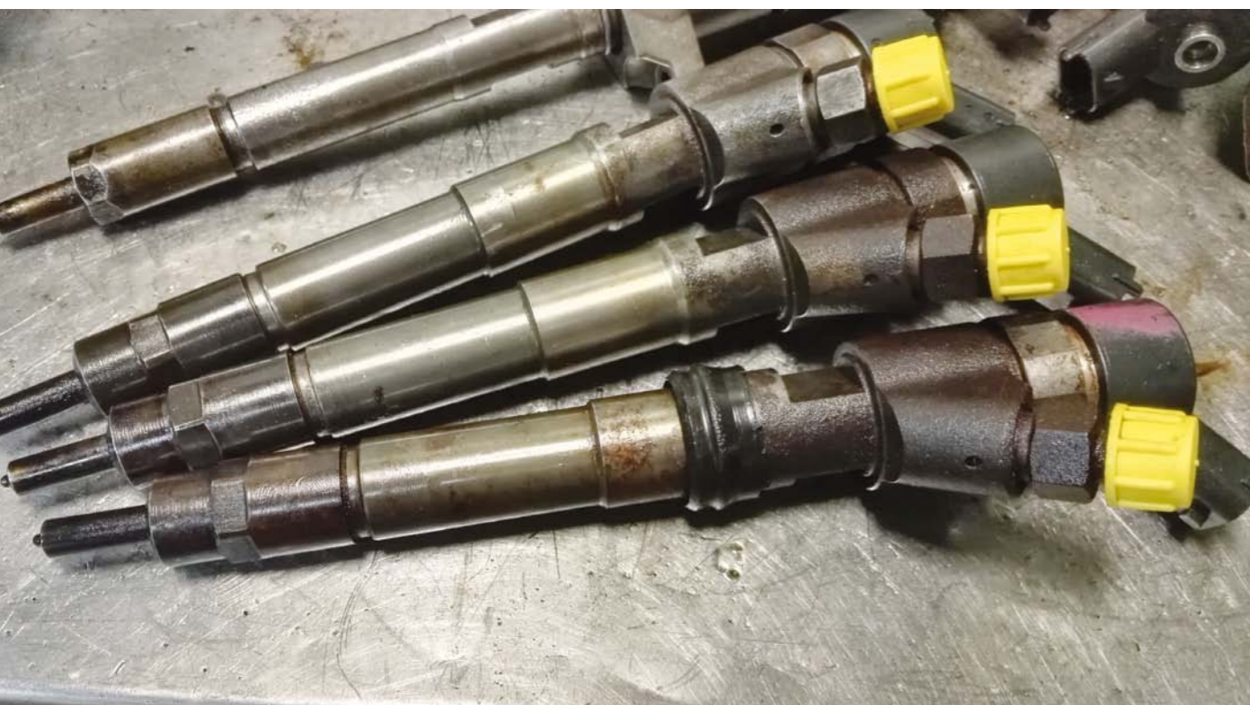
WTRYSKIWACZE COMMON RAIL WYMONTOWANE Z POJAZDU PO DŁUŻSZEJ EKSPLOATACJI
