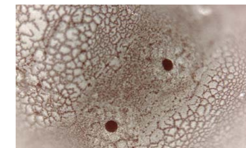
ZANIECZYSZCZONE OSADAMI OTWORY ROZPYLACZA
