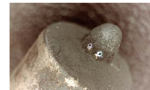
KOŃCÓWKA ROZPYLACZA PO CHEMICZNYM OCZYSZCZENIU OKOLIC OTWORÓW
