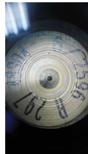
MECHANICZNE USZKODZENIE (ZUŻYCIE) GNIAZDA ZAWORU WTRYSKIWACZA
