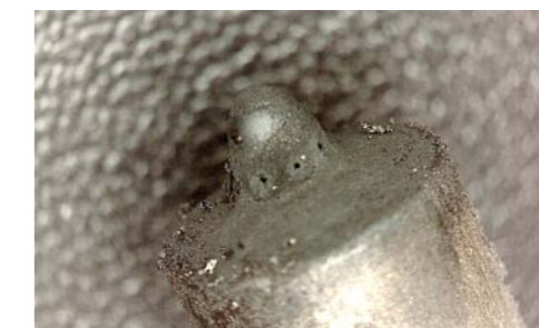
SILNIE ZANIECZYSZCZONA KOŃCÓWKA ROZPYLACZA
