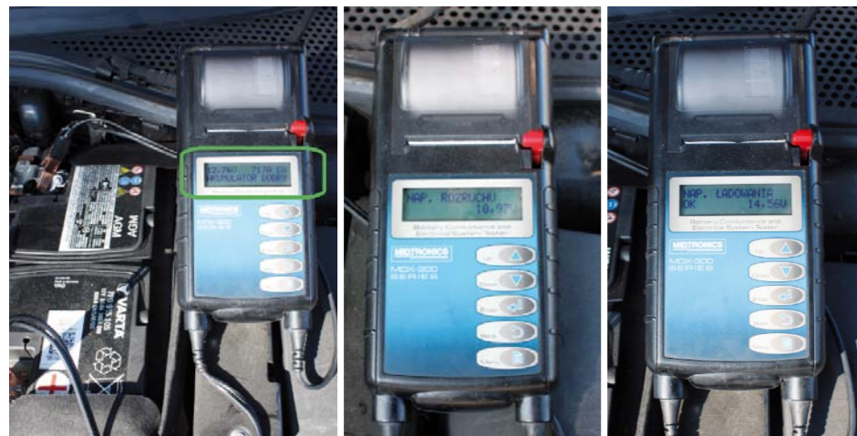
W TEŚCIE PRZEPROWADZANYM PRZY WYŁĄCZONYM SILNIKU BADANE JEST NAPIĘCIE SPOCZYNKOWE I STAN AKUMULATORA (Z LEWEJ). TEST PODCZAS ROZRUCHU SPRAWDZA SPADEK NAPIĘCIA (ZDJĘCIE ŚRODKOWE). TEST ŁADOWANIA (Z PRAWY) PRZEPROWADZANY JEST PRZY PRACUJĄCYM SILNIKU I WŁĄCZONYCH ODBIORNIKACH (ŚWIATA MIJANIA, DMUCHAWA).
