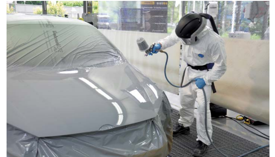
WYPEŁNIACZ STANDOX VOC XTREME FILLER U7600 MOŻNA APLIKOWAĆ DYSZĄ O MNIJSZYM ROZMIARZE, NP. O ŚREDNICY 1,4 MM, I POD MNIJSZYM CIŚNIENIEM. GDYŻ W TEN SPOSÓB OTRZYMUJEMY PŁASKI STRUMIEN I OGRANICZAMY MGŁĘ NATRYSKOWĄ DO MINIMUM, CO UŁATWIA SZLIFOWANIE
