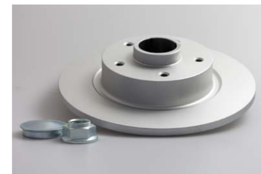
TARCZA HAMULCOWA ZINTEGROWANA Z ŁOŻYSKIEM KOŁA
