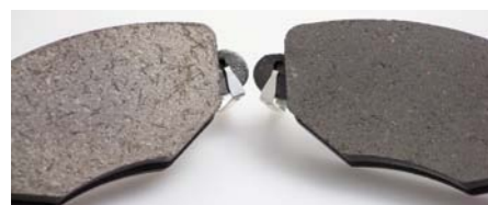
KŁOCEK DELPHI POKRYTY MIEDZIĄ (PO LEWEJ). KŁOCEK DELPHI NIE ZAWIERAJĄCY MIEDZI (PO PRAWĘJ)
