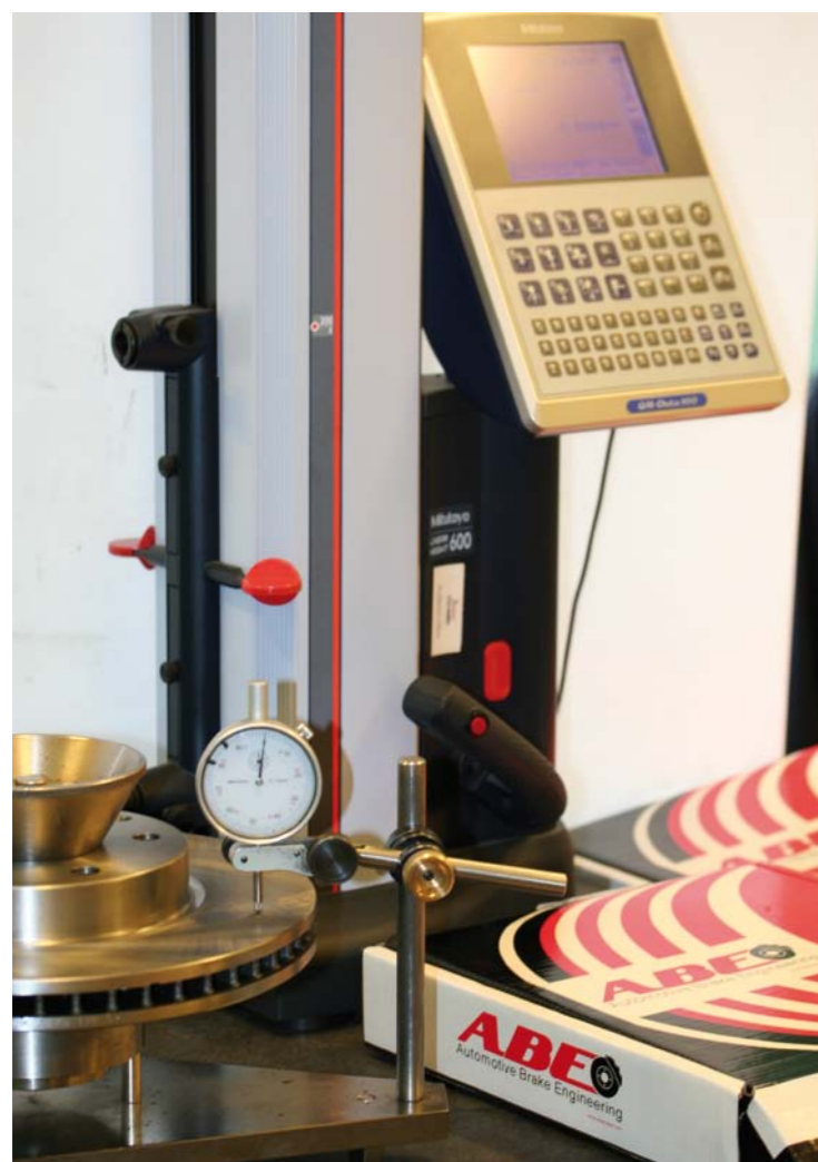
BADANIE PARAMETRÓW GEOMETRYCZNYCH TARCZY NA STANOWISKU POMIAROWYM
