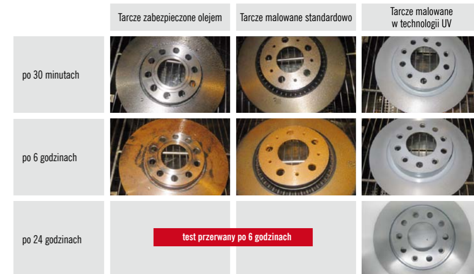
TEST W KOMORZE SOLANKOWEJ DLA PORÓWNANIA ODPORNOŚCI NA KOROZJĘ TARCZ ZABEZPIECZONYCH RÓŻNYMI RODZAJAMI POWŁOK
