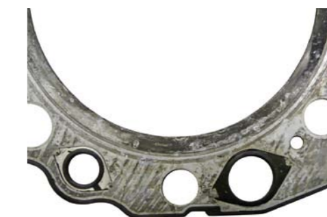
USZKODZONE USZCZELKI ZE ŚLADAMI PRZEDMUCHÓW GAZÓW SPALINOWYCH
