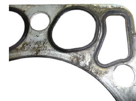
CHARAKTERYSTYCZNE USZKODZENIA POWODUJĄCE PRZEDMUCHY GAZÓW
