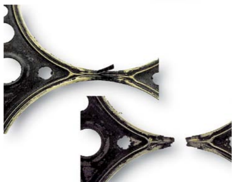
NAJBARDZIEJ PODATNE NA POWSTANIE PRZEDMUCHÓW SĄ PRZEWEŻENIA USZCZELKI POMIĘDZY SĄSIEDNIAMI CYLINDRAMI
