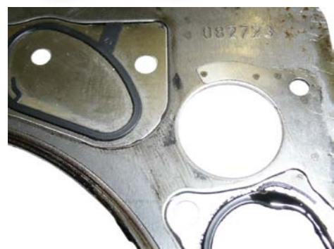
SKUTKI PRZEDMUCHU GAZÓW SPALINOWYCH DO OBIEGU CHŁODZENIA
