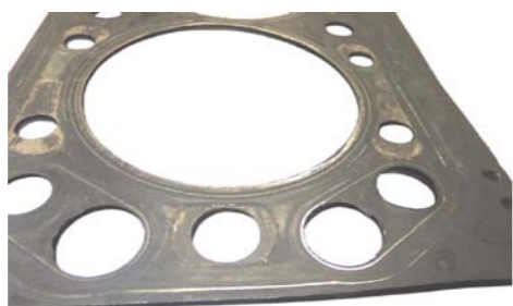
ZNISzcZENIE USZCZELKI Z POWODU PRZECIĄŻENIA TERMICZNEGO (PRZEGRZANIA) SILNIKA
