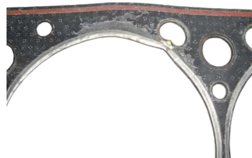
MECHANICZNE USZKODZENIE USZCZELEK BĘDĄCE EFEKTEM BŁĘDÓW MONTAŻOWYCH
