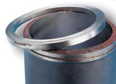
MECHANICZNE USZKODZENIE USZCZELEK BĘDĄCE EFEKTEM BŁĘDÓW MONTAŻOWYCH
