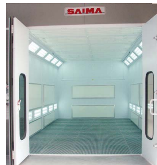
WNĘTRZE KABIN Z POZIOMO ZAMOCOWANYMI PANELAMI ENDOTERMICZNYMI
