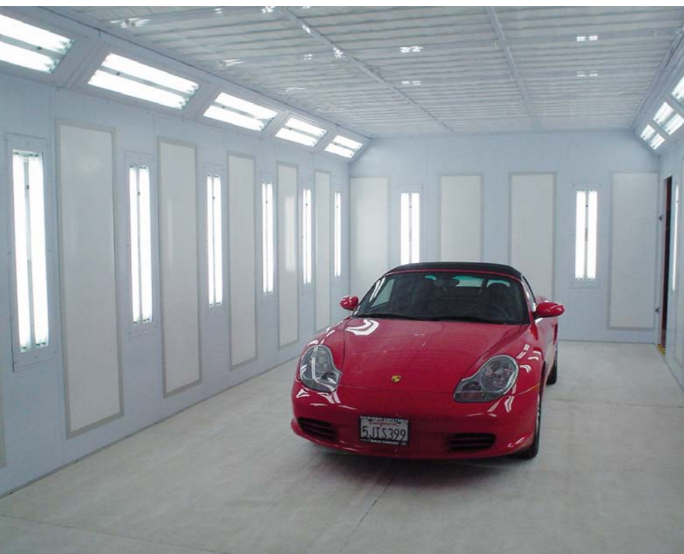
WYKORZYSTANIE PANELI DO PROMIENIOWEGO OGRZEWANIA CAŁEGO NADWOZIA SAMOCHODU
