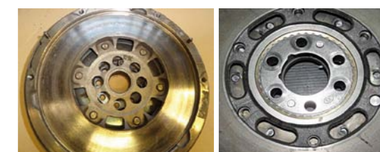
ZABLOKOWANIE DKZ PRZEZ PĘKNIĘTE SPRĘŻYNY | ŚCIECIE NITÓW SPOWODOWANE REZONANSEM
