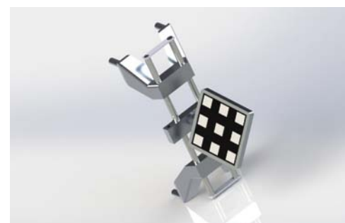
TARCZA REFLEKSYJNA MOCOWANA DO KOŁA BADANEGO POJAZDU
