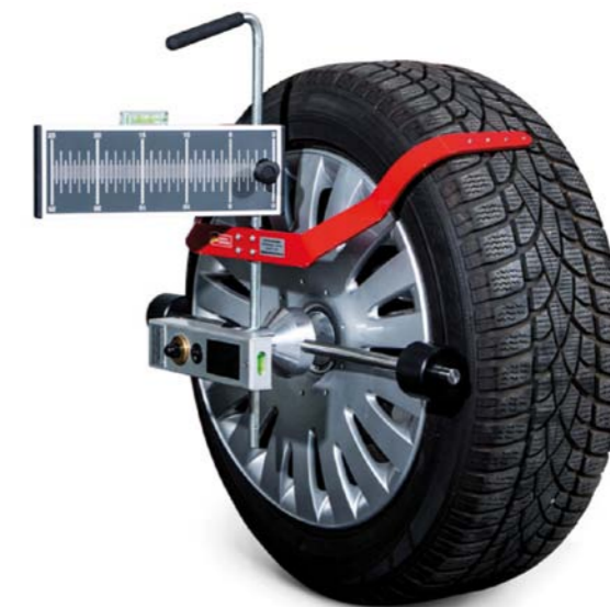
MOCOWANIE BOCZNEGO ELEMENTU BAZOWEGO DO KOŁA OBSŁUGIWANEGO POJAZDU
