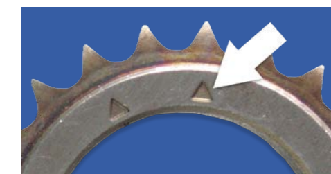
KOŁO ZĘBATE Z PRZETŁOCZENIEM CENTRUJĄCYM I KOŁECZKIEM USTALAJĄCYM 1. centrowanie, 2. kołeczek ustalający
