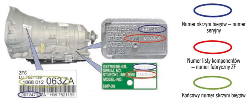
RYS. 3. IDENTYFIKACJA TYPU SKRZYNI AUTOMATYCZNEJ ZF
