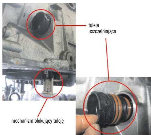
RYS. 9. DEMONTAŻ – ROZŁĄCZENIE GNIAZDA ELEKTRYCZNEGO SKRZYNI BIEGÓW
