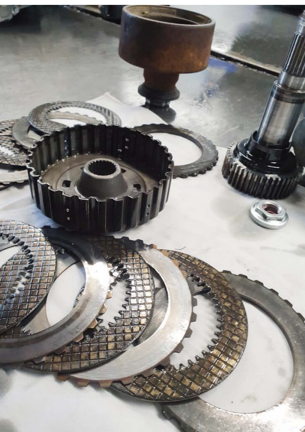
ZANIECZYSZCZONE ELEMENTY SPRZĘGŁA HALDEX BEZPOŚREDNIO PO ZDEMONTOWANIU
