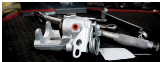
MONTAŻ REGENEROWANEGO ZACISKU W POJEŹDZIE
