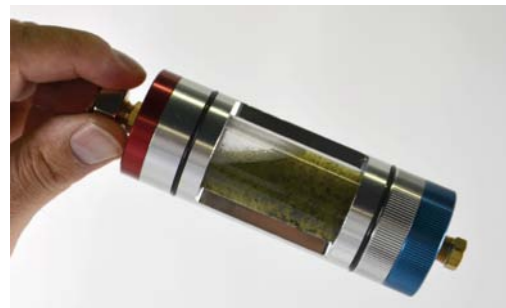
MIESZANKA CZYNNIKA R134A I OLEJU PAG46 (ND8) Z WIDOCZNYMI CZĄSTKAMI GUMY
