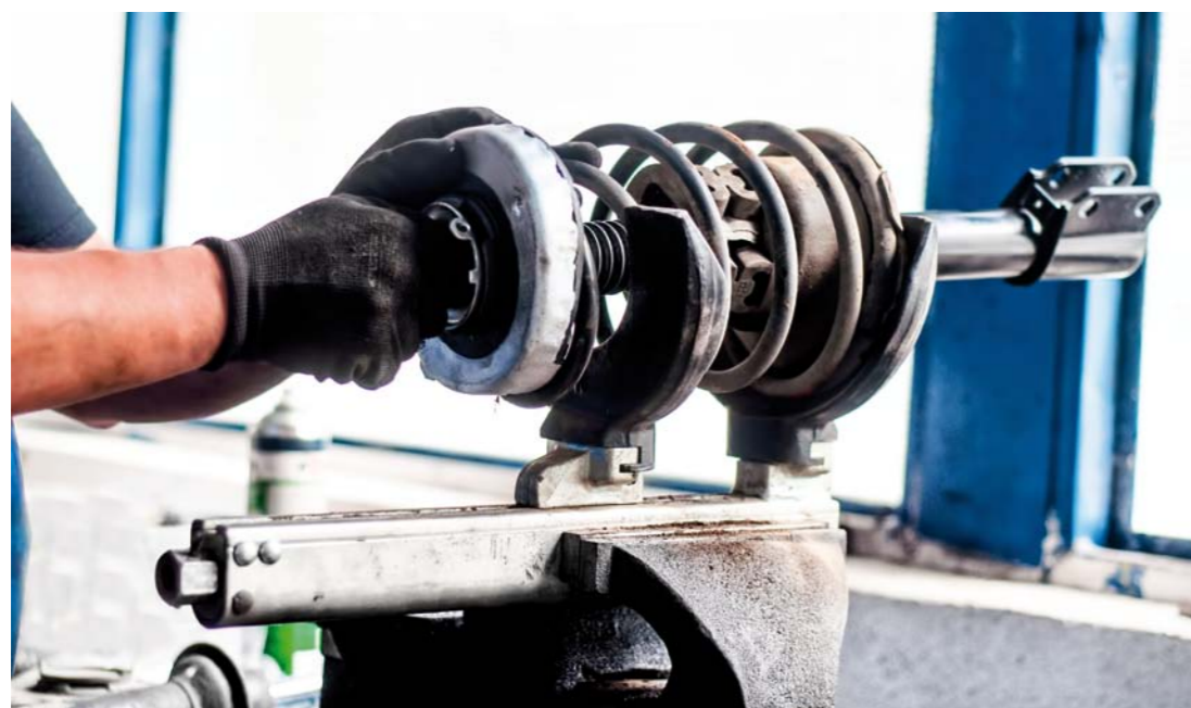
PRAWIDŁOWA ROZBIÓRKA KOLUMNY MCPHERSONA PO JEJ WYMONTOWANIU Z POJAZDU
