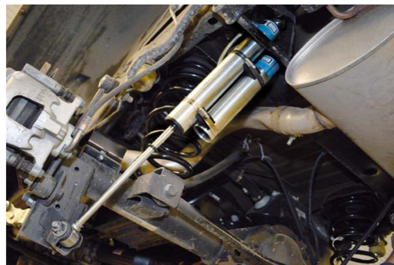
W PODWOZIU TERENOWYM NAJBARDZIEJ ODPOWIEDNIE SĄ KOMPAKTOWE AMORTYZATORY Z DODATKOWYM ZBIORNIKIEM PŁYNU
