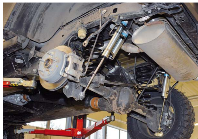
ZWIĘKSZENIE PRZEŚWITU POJAZDU WYMAGA ZASTOSOWANIA DŁUŻSZYCH PRZEWODÓW HAMULCOWYCH
