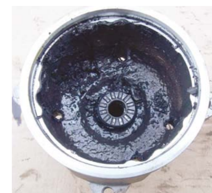
WNĘTRZE USZKODZONEJ SPRĘŻARKI Z OLEJEM, KTÓRY W JEJ WNĘTRZU ZAMIEŃIŁ SIĘ W GĘSTY, CZARNY SZLAM. TEGO TYPU OSAD POWSTAJE PRZY STOSOWANIU W SPRĘŻARKACH DELPHI TECHNOLOGIES NIEZALECANYCH OLEJÓW ESTROWYCH, KTÓRE W WYSOKIEJ TEMPERATURZE ZMIENIAJĄ SWOJĄ KONSYSTENCJĘ
