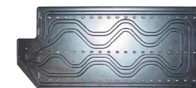
RYŚ. 4. PAROWNIK PŁYTOWY, NA KTÓRYM MONTOWANY JEST AKUMULATOR TRAKCYJNY POJAZDU HYBRYDOWEGO
