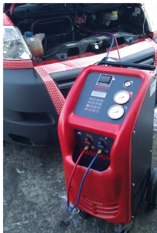
PRZY OBSŁUDZE SYSTEMÓW KLIMATYZACJI NIEZBĘDNE JEST WYKORZYSTANIE STACJI SERWISOWEJ
