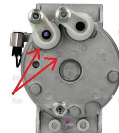
SPRĘŻARKA KLIMATYZACJI NISSENS Z UKAZANYMI PORTAMI SSANIA I TŁOCZENIA
