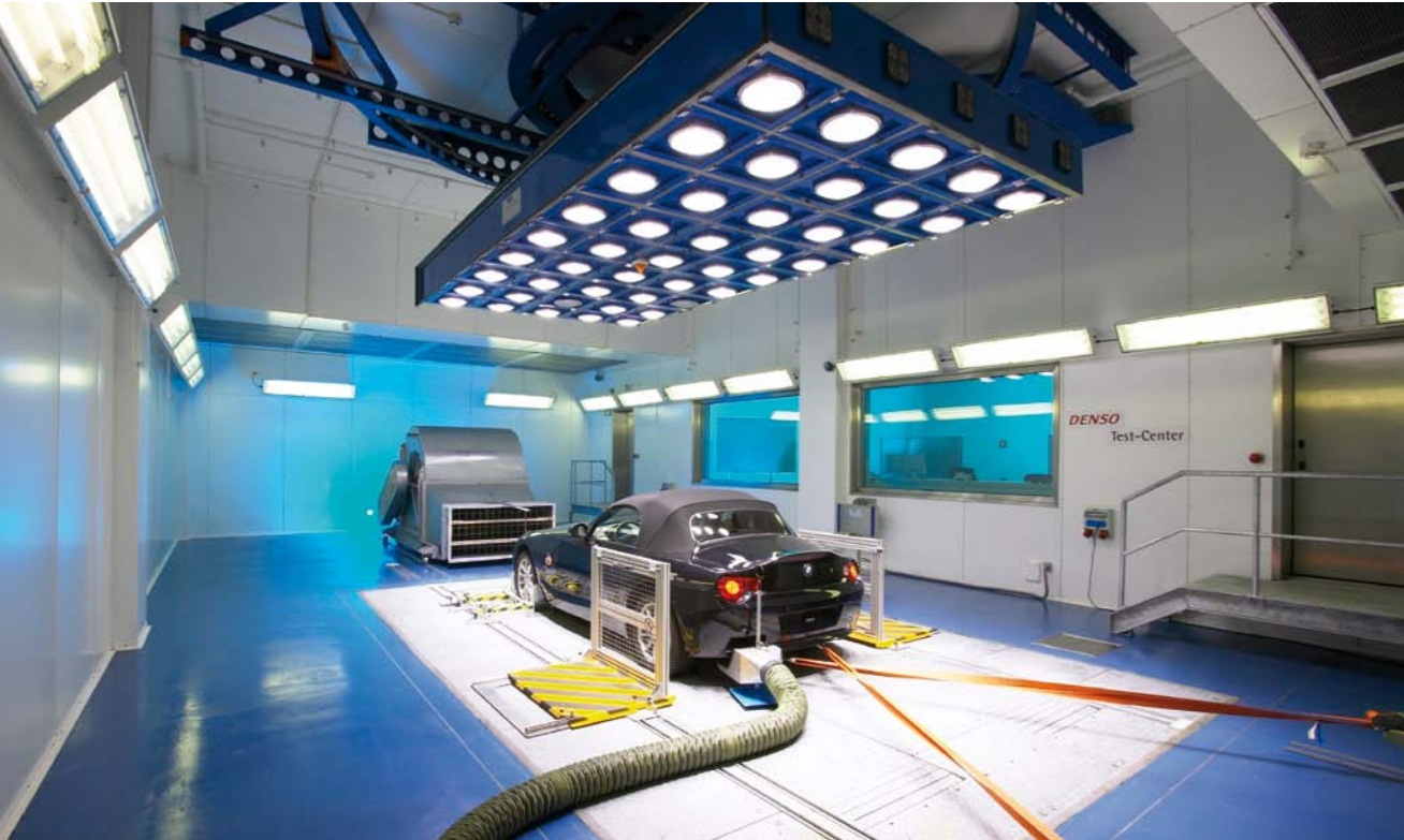
KOMORA KLIMATYZACYJNA OŚRODKA TESTOWEGO DENSO W ECHING
