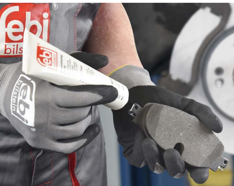
MIEJSCA WSPÓŁPRACY KŁOCKA I ZACISKU HAMULCOWEGO NALEŻY PODCZAS MONTAŻU POSMAROWAĆ PASTĄ CERAMICZNĄ, CO ZABEZPIECZY KŁOCEK PRZED ZAPIEKANIEM I ZAPEWNI SWOBODĘ JEGO RUCHU
