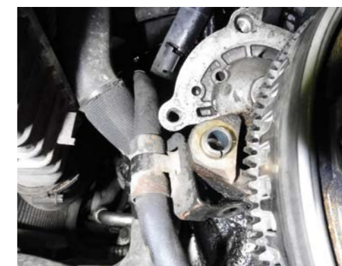
FOT. 4. ODPOWIEDNIO USTAWIONA TULEJA PROWADZĄCA W BLOKU SILNIKA GRUPY PSA
