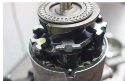
ZANIECZYSZCZENIE ŚRODKIEM USZCZELNIAJĄCYM JEST WIDOCZNE NA PŁYCE WYCHYLNEJ I TŁOKACH
