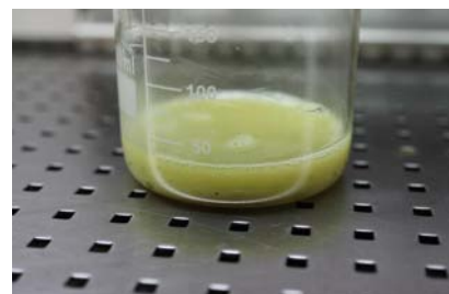
OLEJ ZANIECZYSZCZONY ŚRODKIEM PŁUCZĄCYM – WIDOCZNE MLECZNE PRZEBARWIENIA
